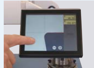
Sistema electrónico de medición para el proyector Measurement electronics for projector
