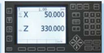
Sistema electrónico de medición para el proyector Measurement electronics for projector
